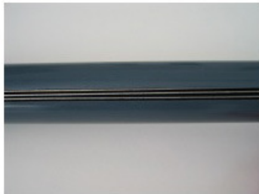
Het elektrodepakket weggewerkt in de buis
